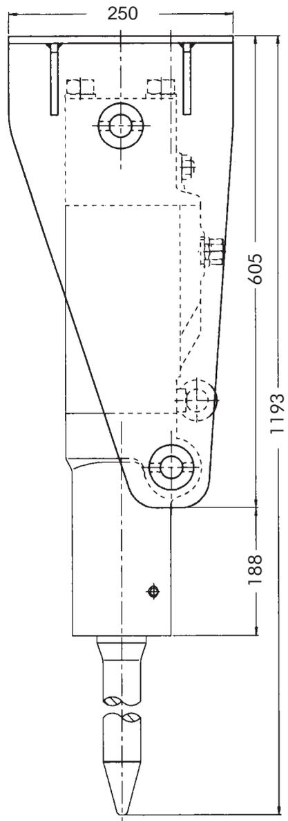
Zum Anbau an ein vorhandenes Trägergerät ist noch ein zusätzliches Verbindungsstück, passend zum Trägergerät, erforderlich.
